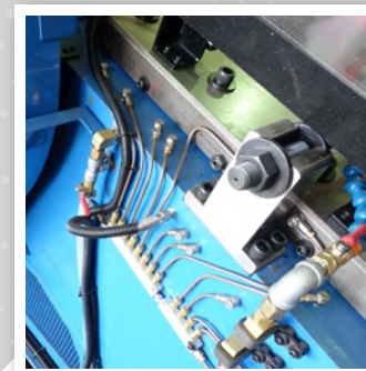
1. 主滑台潤滑油路 2. 主滑台溫度感測
