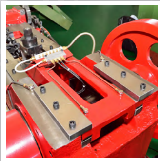
主滑台採用OVERARM之 設計，確保主滑台長期 之穩定性及精密度。
